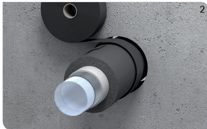
Bandage um Rohrleitung (bzw. Dämmung) legen (Lagenzahl beachten!) und Überlappung (ca. 20 mm) verkleben.
