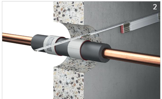
2. Je Bauteilseite eine Bandagenhälfte so anordnen, dass 15 mm – entspricht der Zollstockbreite – aus dem Bauteil hervorsteht.
