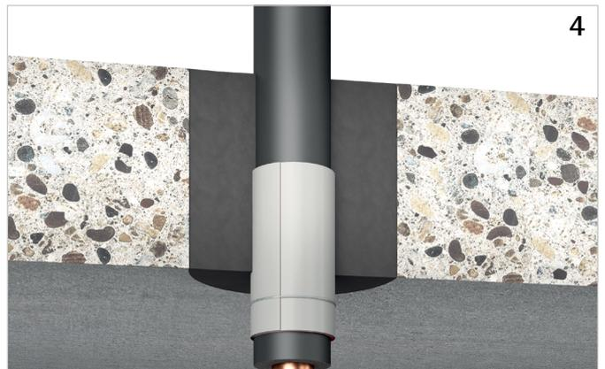
4. Ringspalt verschließen, z. B. mit: – GFM Brandschutzmörtel, NOVASIT BM, Beton, Zementmörtel oder Gips
