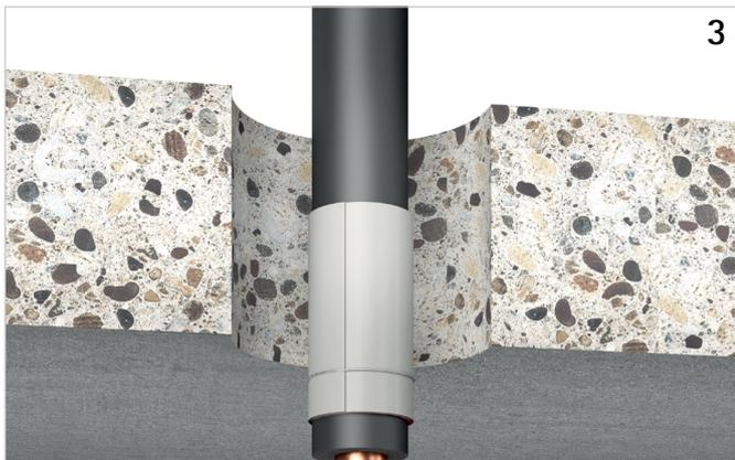
3. Rohrbandage mit min. 1 Stück Wickeldraht  $d \geq 0,6 \text{ mm}$  unterhalb der Decke fixieren.
