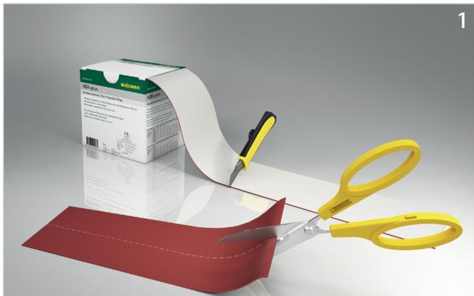
1. Das Brandschutzgewebe ist werkseitig mittig vorgeschlitzt. Bandage ablängen und entlang der vorgeschlitzten Linie mit einem Cuttermesser oder Schere mittig teilen.
