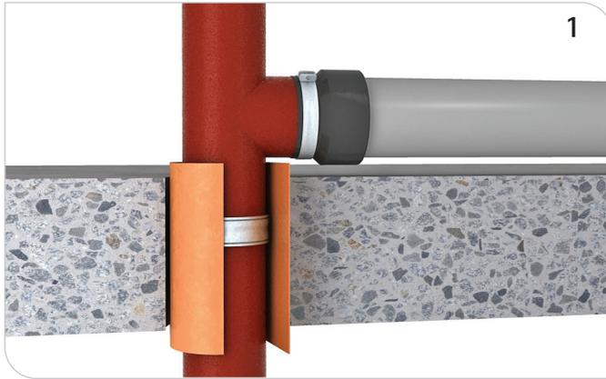
Pacifyre® SML Flex Brandschutzmatte einlagig um das Rohr legen, in das Bauteil schieben und andrücken.
