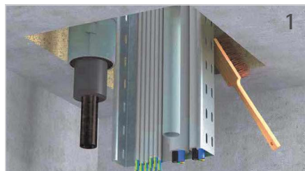
Deckenschott säubern und verlorene Schalung mit Klebeband erstellen.
