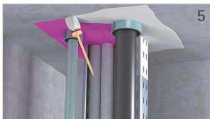
Tangit FP 800 Brandschutz-Anstrich unterhalb des Deckenschotts auf den Schaum und 3 cm des angrenzenden Bereichs, bzw. 15 cm auf die Kabel(-trasse) auftragen.
