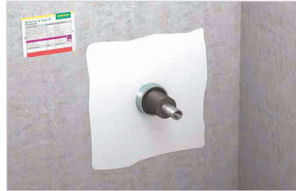
Nicht brennb. Rohr mit brennb. Dämmung.
