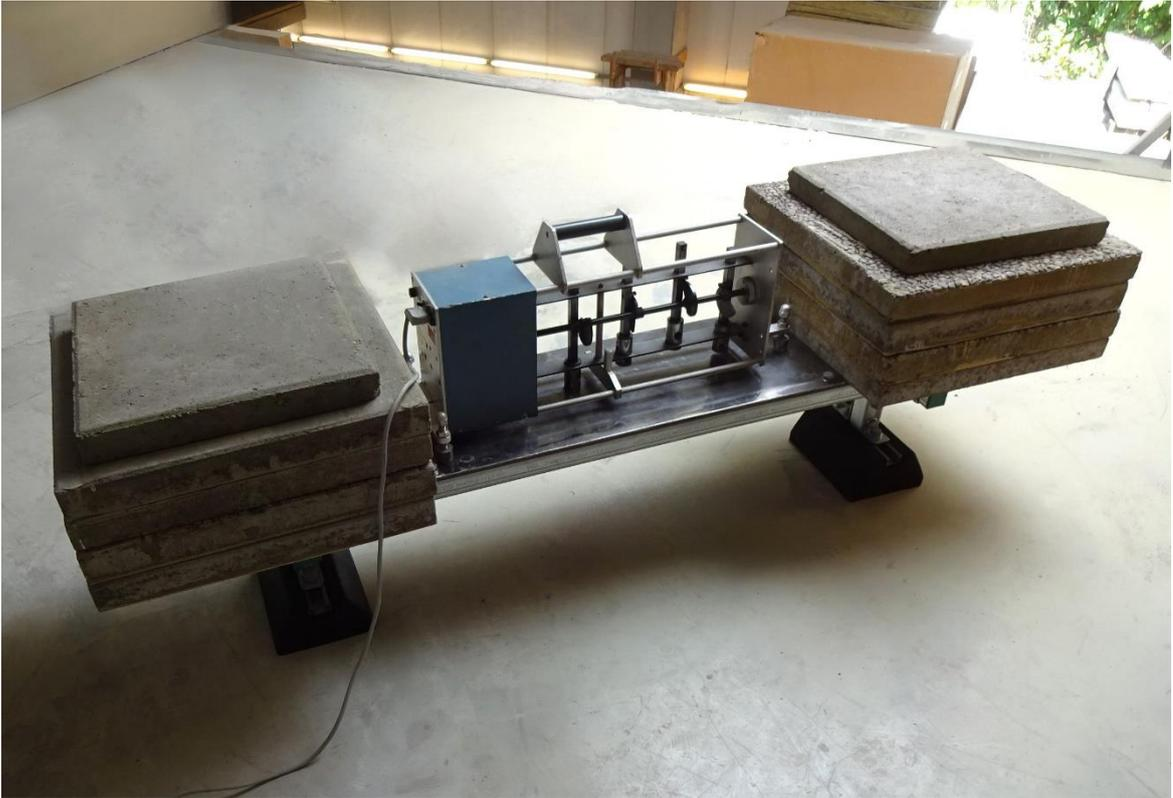
Bild 6: Typ A, Länge = 250 mm, 150 kg Zusatzlast je Montagefuß, auf EPS-Dämmunterlage (d = 200 mm)
