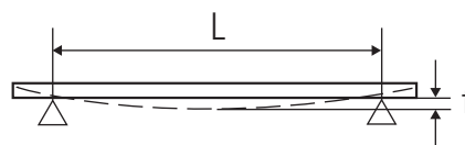
Imagen 1: Cálculo de cargas, f = máxima desviación, L = longitud
