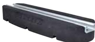
Walraven Ursus está diseñado para soportar sistemas de tuberías pequeñas y lineales, así como conductos y bandejas de cables. Es ideal para instalaciones de clima, pasarelas y otros tipos de instalación en cubiertas planas. El soporte Walraven Ursus está hecho de caucho vulcanizado resistente a los rayos UV e incluye una pieza de carril de fijación Walraven RapidStrut®, con tratamiento de superficie Walraven BIS UltraProtect® 1000.
